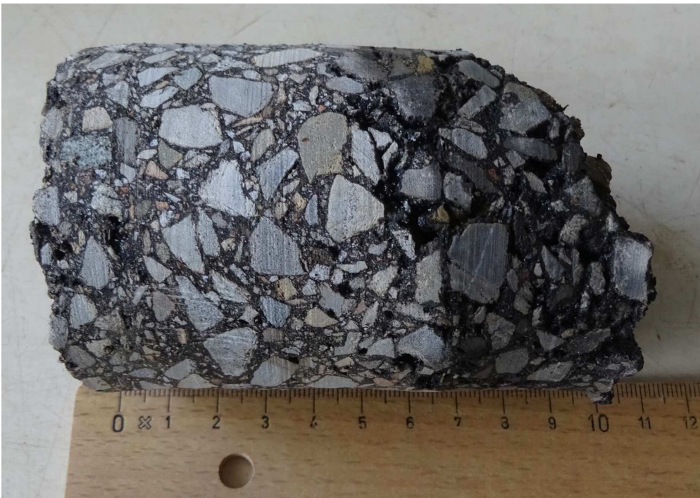
Abbildung 4: Fotodokumentation – Asphaltkern RKS 2 – BV Friedrichstraße
