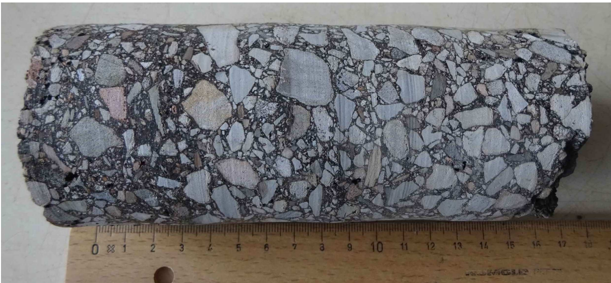
Abbildung 6: Fotodokumentation – Asphaltkern RKS 4 – BV Friedrichstraße
