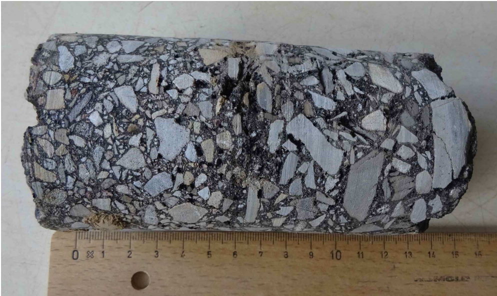
Abbildung 3: Fotodokumentation – Asphaltkern RKS 1 – BV Friedrichstraße
